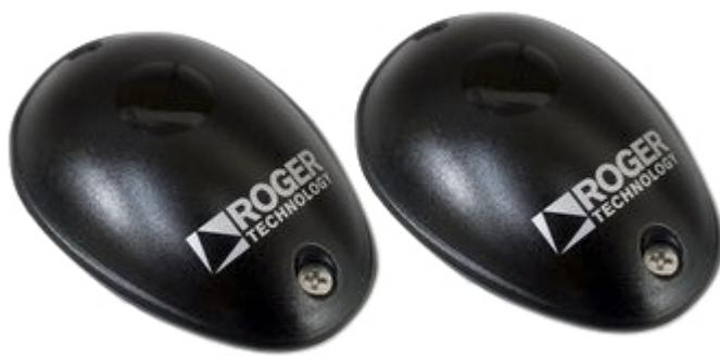
Par de fotocélulas de exterior sincronizadas. Las fotocélulas de exterior R90/F2ES son detectores de presencia sincronizada de tecnología infrarrojo alimentadas con 12/24V CA/CC, que permiten detectar obstáculos presentes en el eje óptico entre el transmisor (TX) y el receptor (RX), a utilizar para entradas automáticas. Estas fotocélulas están destinadas a instalaciones con superficies de fijación planas y paralelas entre sí que deben permitir un correcto centrado entre la fotocélula TX y la RX.
